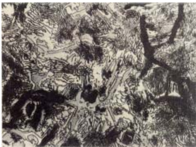
写真3 佐賀24ポンドカノン砲の顕微鏡写真（倍率不明）
