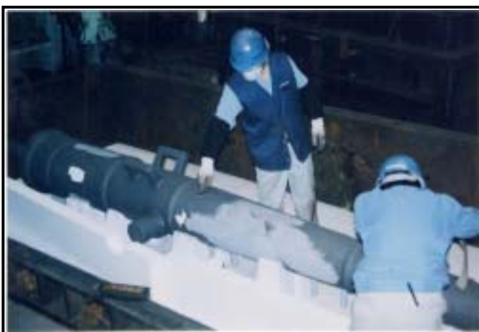
写真6 込め付け台を使った砂込めの準備
