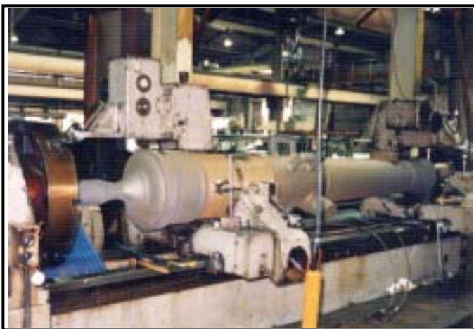
写真8 B T A方式による砲芯加工
